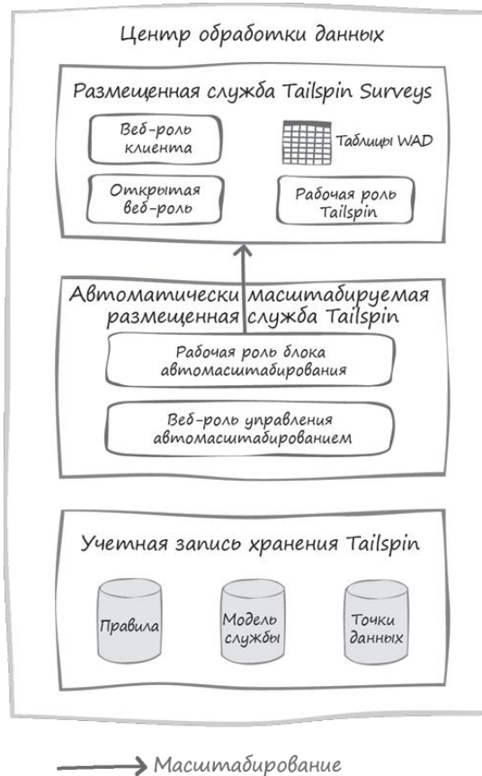
Рис. 2 Приложение Tailspin Surveys, развернутое в едином центре обработки данных.
